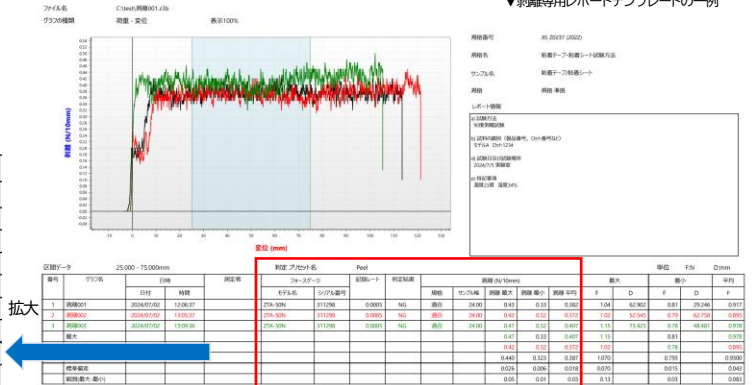
▼剥離専用レポートテンプレートの一例
